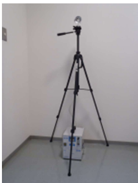
47φフィルター-ホウ 柴田科学機器工業 アスベストサンプリッングポンプ AIP-105型
